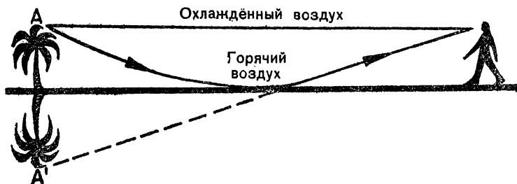
Рис. 9. Схема хода лучей над нагретой поверхностью.
